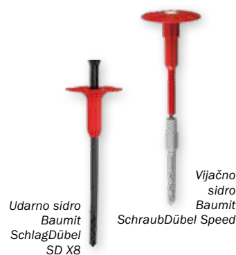
Baunit pritrdilna sidra postavljamo po shemi mreže, maksimalno 40 x 40 cm.
