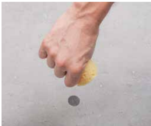
Enostavni test vpojnosti podlage
