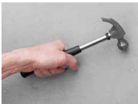
Stanje podlage je mogoče oceniti na preprost način, z udarci s kladivom.
