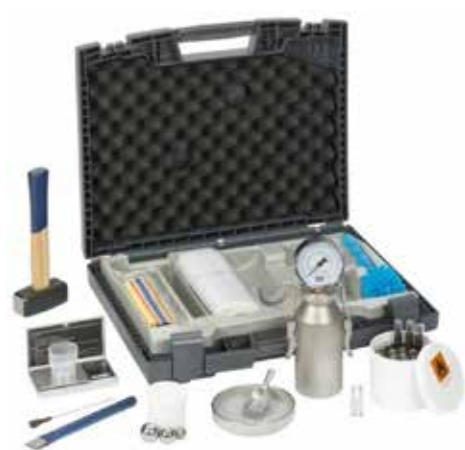
Set za merjenje vlažnosti po metodi CM
