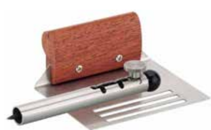
Naprava za preizkušanje trdnosti podlage
