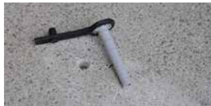
Merilnik vlage z zunanjo sondo
