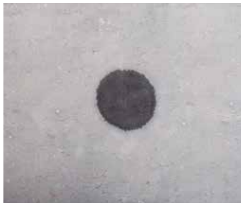
Z opazovanjem vpijanja navlažene površine lahko ocenimo vpojnost podlage
