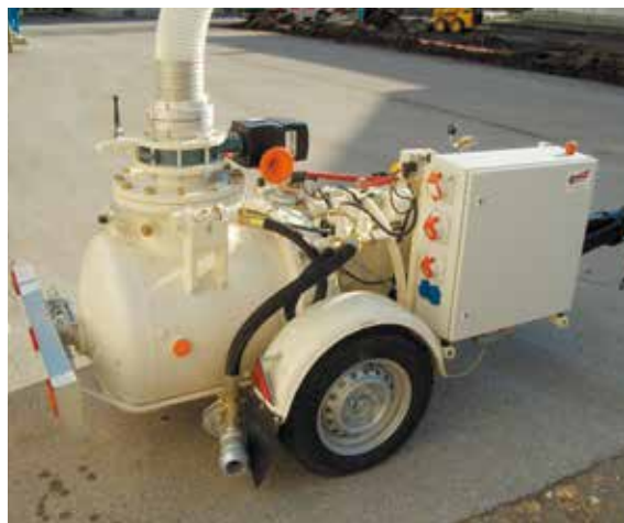
Slika 23: Stroj za mešanje estriha - elektro pogon
