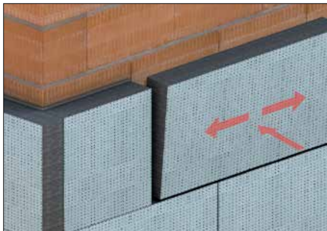
Slika 18: Polaganje izolacijskih plošč
