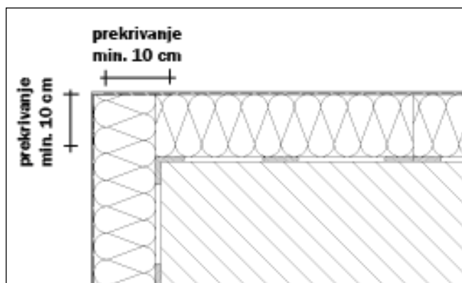
Slika 31: Prikaz armiranja (zunanjega) vogala objekta
