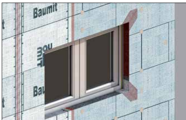
Slika 30: Prikaz armiranja špalet
